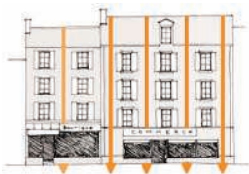
Les pleins et les vides (les baies) des étages ne se poursuivent pas en rez-de-chaussée.
