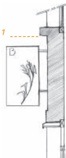
Enseigne en drapeau positionnée sous l'appui de la baie du 1er étage (1).
